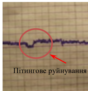
Рисунок 3.24 – Стрибок моменту тертя при пітинговому руйнуванні поверхневого шару цементованого зразка
