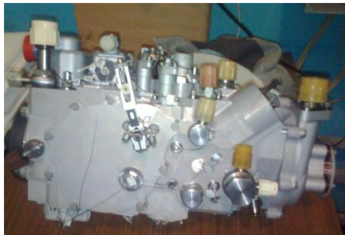
Паливний насос-регулятор шестеренного типу НР-3000
