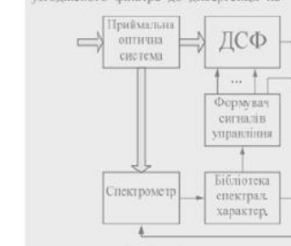
Рис. 2. Структурна схема оптико-електронної системи з динамічною спектральною фільтрацією, що реалізує адаптивний алгоритм
